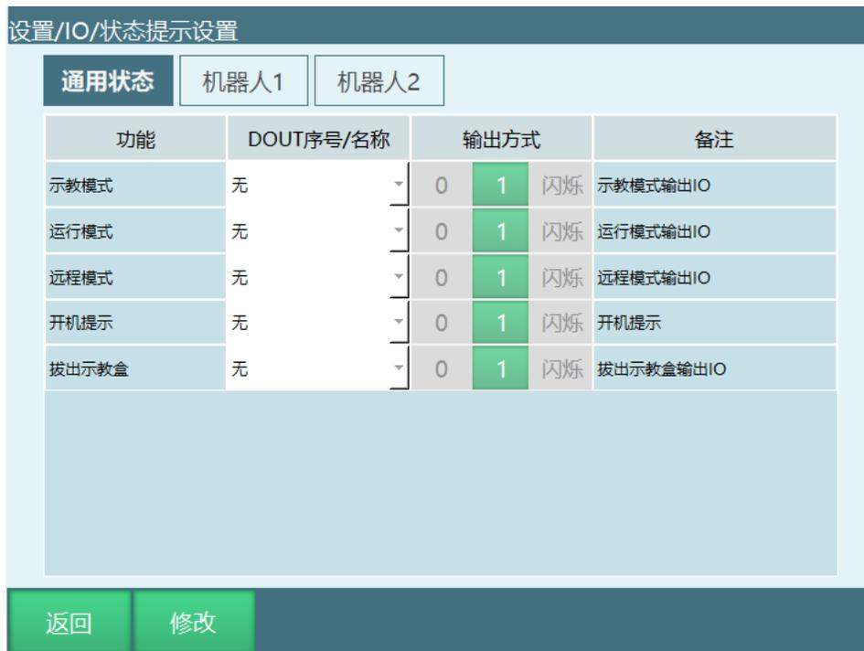
**Robot1 运行：** 机器人 1 运行时对应 DOUT 口输出高电平
