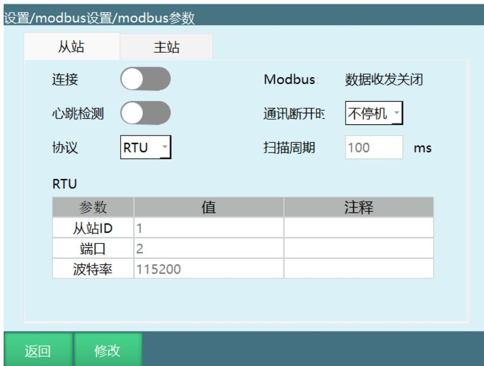
作为从站的时候可以设置心跳检测，确认跟主站的通讯状态，以及通讯断开时，是否停机。协议可以选择 RTU 和 TCP，以及其对应的端口设置。
