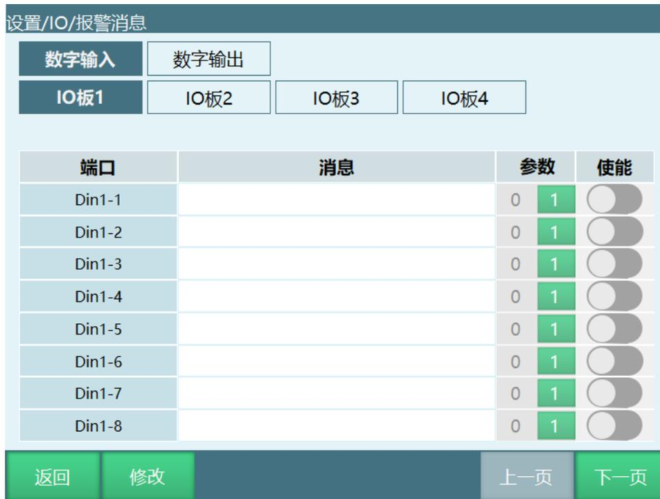
例如：设置 IO 紧急停止信号端口为 15 用于接防碰撞 IO, 1 触发、0 解除；则触发 DIN1 会报“机器人 1IO 紧急停止被触发”；此时在报警消息界面找到 DIN1，消息栏输入“触发防碰撞”，则再次触发 DIN15 时报错“触发防碰撞”，不会在报“机器人 1IO 紧急停止被触发”。
