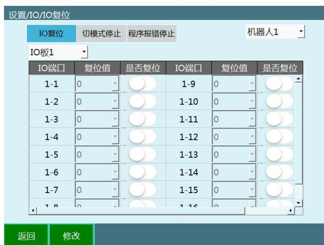
**IO 复位：**在远程模式时，给复位信号，机器人执行回到复位点的动作，同时会将该界面设置的 IO 端口复位到复位值。
