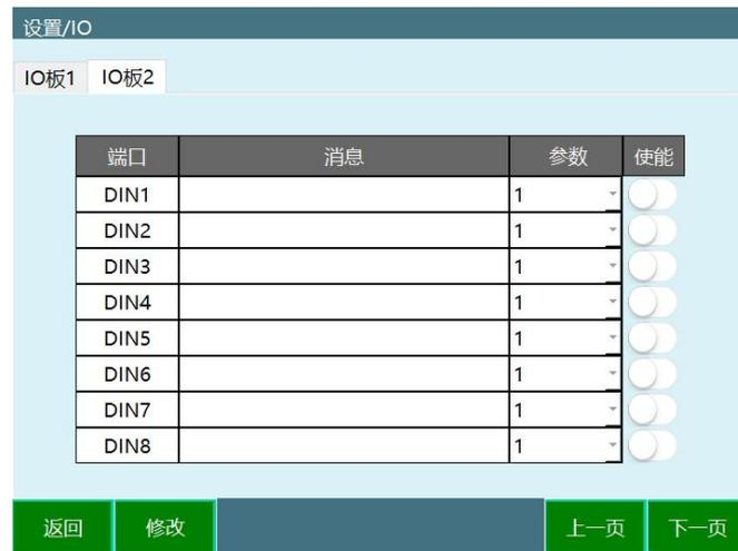
例如：设置 IO 紧急停止信号端口为 15 用于接防碰撞 IO, 1 触发、0 解除；则触发 DIN15 会报“机器人 1IO 紧急停止被触发”；此时在报警消息界面找到 DIN15，消息栏输入“触发防碰撞”，则再次触发 DIN15 时报错“触发防碰”。
